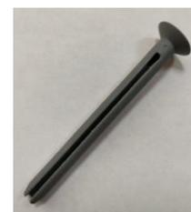
**Элемент крепежа (саморез FixSD80 и FixSD130)** Специальный пластиковый шуруп, длиной 80 и 130мм, для жесткого крепления пенополистирольных панелей между собой. Обеспечивает надёжное соединение элементов каркаса. Не восприимчив к перепадам температур, влажности, и коррозии благодаря чему может применяться как в интерьерных так и в экстерьерных работах.
